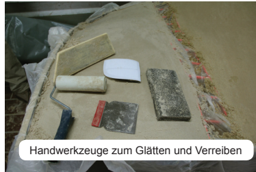
mechanisches Verdichten, Glätten und Formen
