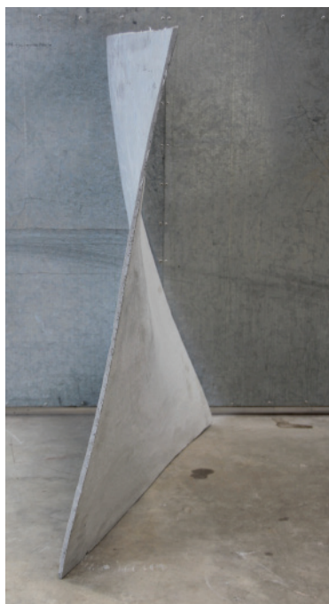
Fig. 10 Erste Experimente mit einer frei geformten, abgezogenen Oberfläche, mit vakuumierter Silikon schalungsfläche
