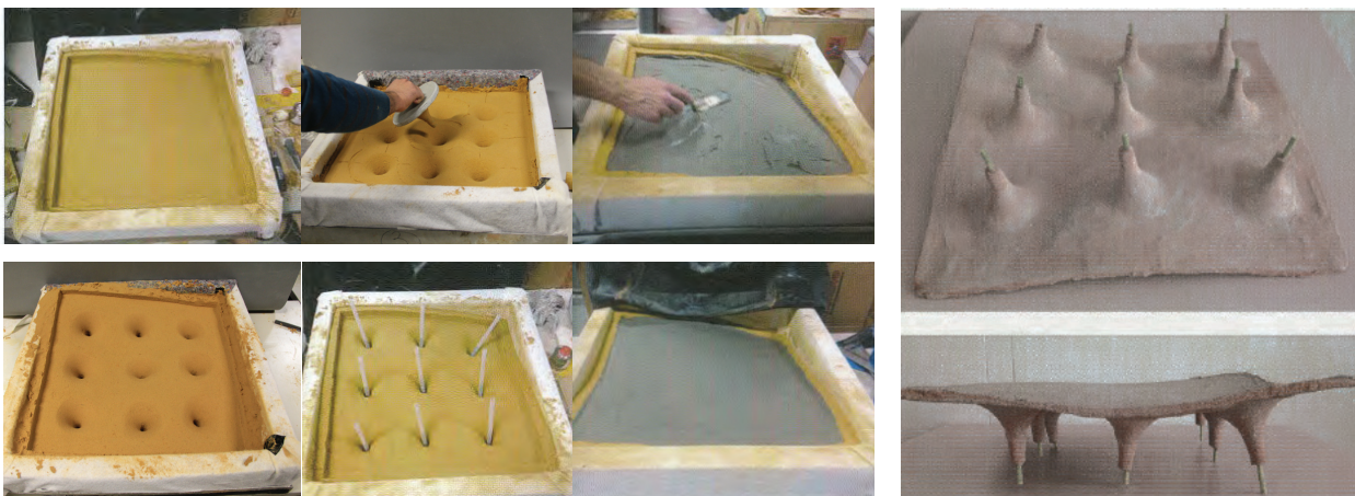
Fig. 13 Entwicklung eines möglichen teilautomatisierten Schalungsherstellungsprozesses.
