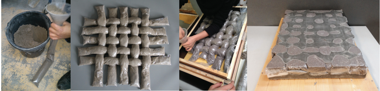
Fig. 11 Spielerische Experimente mit Sand und seiner Verwendung als Schalungsmaterial
