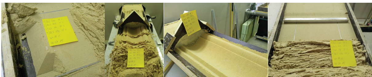
Fig. 7 Untersuchung der Oberflächenqualität der Sandoberfläche, die aus verschiedenen Sandrezepturen hergestellt wurden
