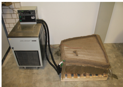
Fig. 9 Versuche mit gefrorenem Sand, der später z.B. mit Fräsmaschinen bearbeitet werden kann.
