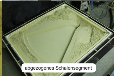
Fig. 8 Impressionen von den ersten Erkundungen und Untersuchungen der Verarbeitungsmöglichkeiten von Formsand
